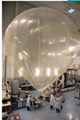
On aperçoit ici un impressionnant ballon gonflé à l'hélium destiné à surélever l'appareil au moment des tests.
